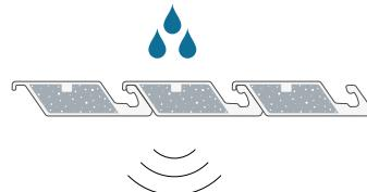
DE (\*) Ergebnisse eines Tests, der unter kontrollierten Bedingungen durchgeführt wurde, bei denen ein starker Regen auf einer 800x500 cm großen Struktur simuliert wurde. Das Mikrofon wurde 50 cm unterhalb der Unterseite der Lamellen platziert.
